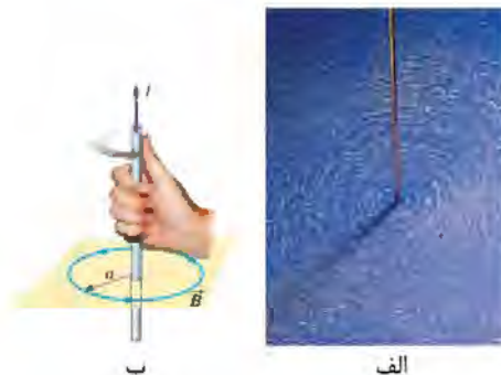
شکل ۱۰-۱۷: الف) میدان مغناطیسی اطراف سیم راست حامل جریان. ب) قانون دست راست ۲ برای تعیین جهت میدان
