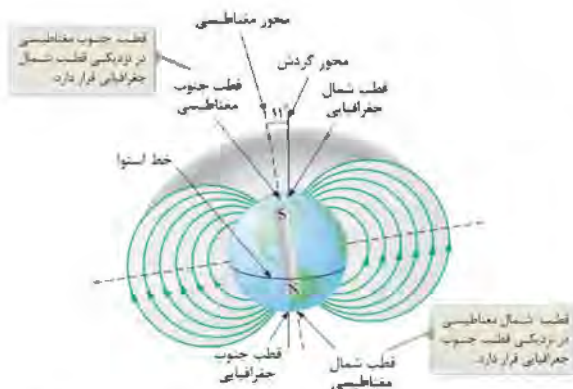
شکل ۱-۵: میدان مغناطیسی زمین و خطوط میدان اطراف آن.
