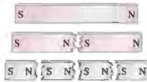
شکل ۱-۷: شکستن یک آهن‌ربای میله‌ای باعث می‌شود که هر بخش یک آهن‌ربای میله‌ای جدید باشد.
