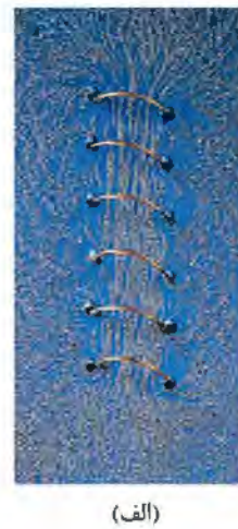
شکل ۱۰-۳: الف) خطوط میدان مغناطیسی اطراف سیم‌لوله‌ی حامل جریان. ب) قانون دست راست ۲ برای تعیین جهت میدان مغناطیسی درون سیم‌لوله‌ی حامل جریان الکتریکی. ب) میدان الکتریکی درون سیم‌لوله را می‌توان یکنواخت در نظر گرفت.
