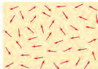
شکل ۱-۸: سمت‌گیری کاتوره‌ای دو قطبی‌های مغناطیسی در غیاب میدان مغناطیسی خارجی.
