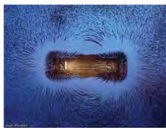
شکل ۱-۱۰: قطب‌های آهنربای میله‌ای.
