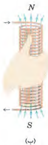
شکل ۱۰-۳: الف) خطوط میدان مغناطیسی اطراف سیم‌لوله‌ی حامل جریان. ب) قانون دست راست ۲ برای تعیین جهت میدان مغناطیسی درون سیم‌لوله‌ی حامل جریان الکتریکی. ب) میدان الکتریکی درون سیم‌لوله را می‌توان یکنواخت در نظر گرفت.
