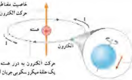
خاصیت مغناطیسی ناشی از حرکت الکترون به دور خودش
