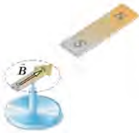
شکل ۱-۳: عقربه‌ی مغناطیسی برای تعیین جهت بردار میدان مغناطیسی استفاده می‌شود.
